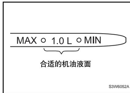
6. 检查机油尺上的机油，确定机油未受到污染。
